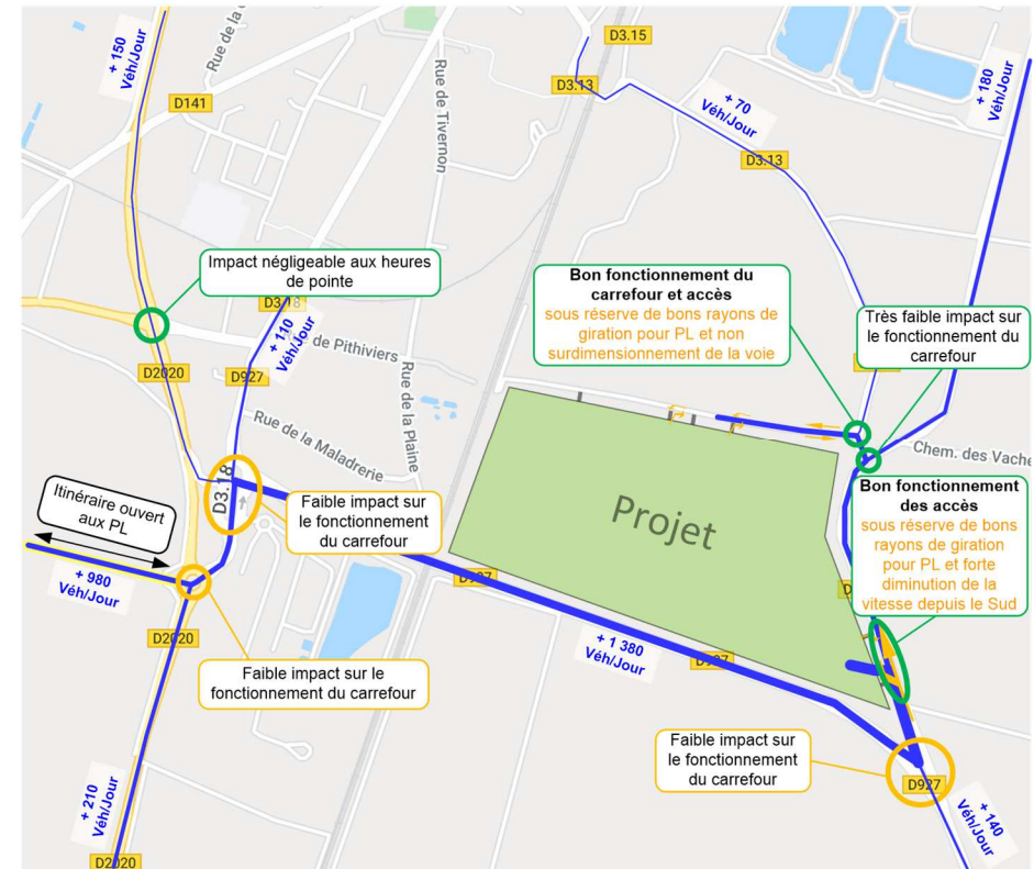
Synthèse des conditions de circulation en situation finale du projet (avec les trois bâtiments)
